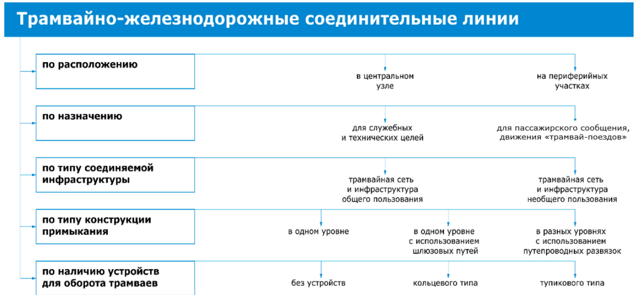
Рисунок 2.13 — Авторская система типизации трамвайно-железнодорожных соединительных линий
