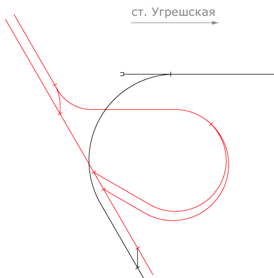
Рисунок 2.12 — Схема путевого развития гейта на конечной станции Угрешская, г. Москва
