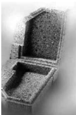
Рисунок 3 — Образец сжатой крошки пенополиуретана (звукопоглощающая оболочка)
